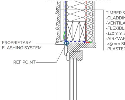
TIMBER WALL -CLADDING -VENTILATED CAVITY -FLEXIBLE WALL UNDERLAY OVER PLYWOOD -140mm STUD + FIBRE INSULATION R4.0 -AIR/VAPOUR CONTROL MEMBRANE -45mm SERVICE CAVITY + FIBRE INSULATION R1.2 -PLASTERBOARD
